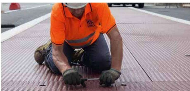
Pont-bascule en acier peint avec capteurs numériques ou analogiques et trappes transversales pour accéder aux capteurs de charge.
