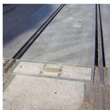
Système de pesage pour wagons de chemin de fer en acier peint sur lequel sont fixés des rails de déplacement type 50/60 UNI. Les dimensions et la portée du pont ainsi que le type de rail peuvent être personnalisés sur demande.
