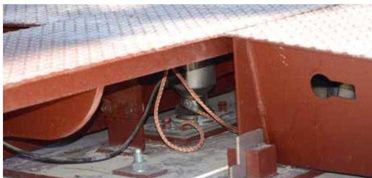
Pont-basculé en acier peint, version avec encombrement de seulement 31 cm du sol pour des installations typiquement surélevées.
