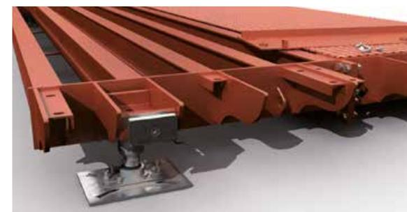
**STRUCTURE MÉTALLIQUE PORTEUSE** à poutres longitudinales, spécialement dimensionnée pour maintenir inaltérées les caractéristiques de résistance et précision de l'équipement de pesage même en conditions d'applications intensives. Le traitement de sablage et le vernissage suivant « rouge oxyde » à haut pouvoir anti-corrosion de toutes les parties métalliques assurent la protection maximale contre l'oxydation.
