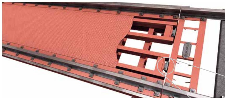
**BUTÉES** réalisées avec des tampons antichoc pour remédier à la détérioration du ciment dans les zones de contact avec le pont lors du freinage du véhicule
