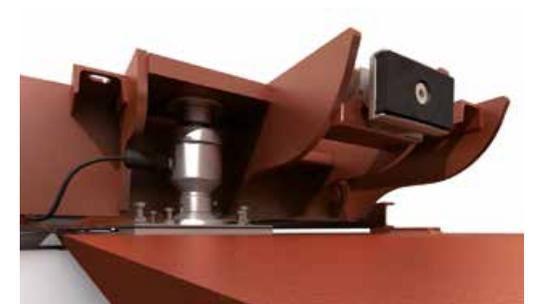
**LE DOUBLE BORD DE TÊTE** avec les **BUTÉES** réalisées avec des tampons en matériau spécial antichoc, sont extrêmement importants pour remédier à la détérioration du pavage dans les zones de contact avec le pont lors du freinage du véhicule (en présence de rampes en ciment).
