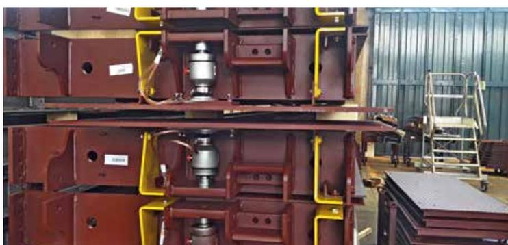
Pont-basculé modulaire en acier peint, version avec une hauteur de seulement 28,5 cm, pour des installations surélevées. Équipé avec des capteurs de charge NUMÉRIQUES réalisés par Cooperativa Bilanciai, mod. CPD-M INSTALLATION RAPIDE : le système de charnières permet l'ouverture pliante des panneaux en évitant de devoir les assembler lors de l'installation.
